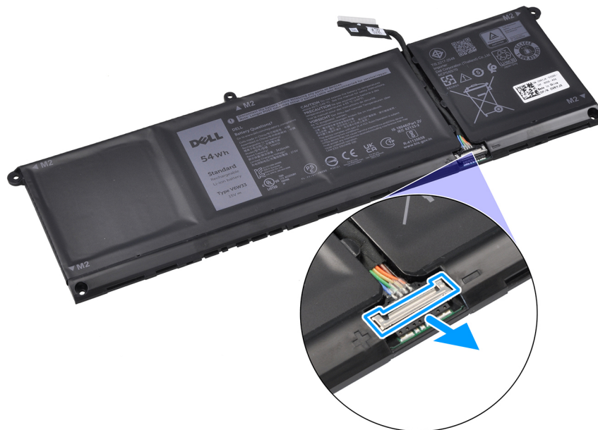
Skica 23. Sprostitev priključka kabla baterije
